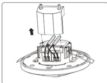
① Las aberturas de la tapa protectora pueden adaptarse al diámetro de cable.
